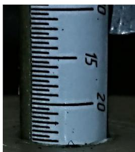
Рисунок 3.15 – Приспособление для измерения погружения штампа
