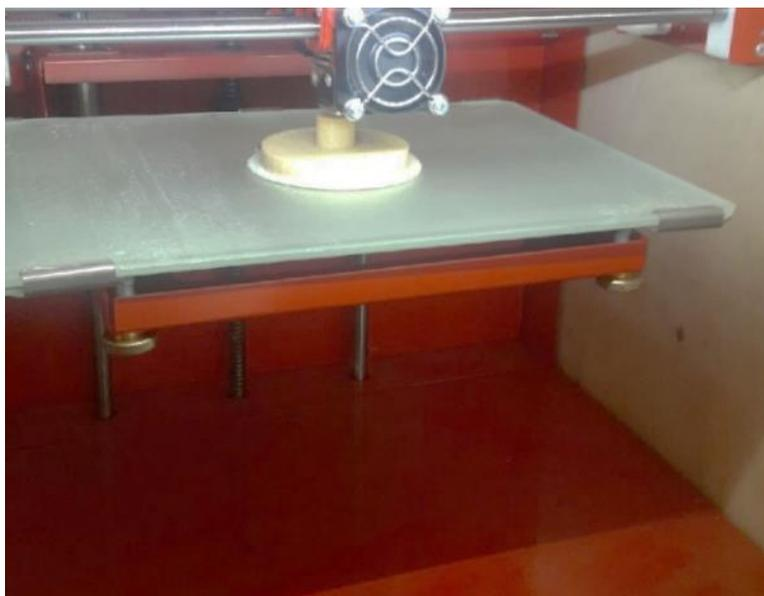
**Рисунок 3.12 – Процесс изготовления направляющей втулки на 3D-принтер MAGNUM CREATIVE 2 UNI**
