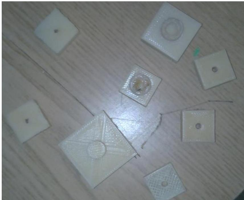
Рисунок 3.10 – Аутригеры, изготовленные на 3D принтере
