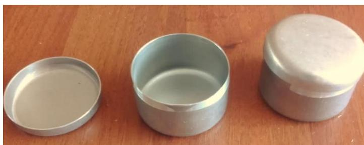
Рисунок 3.16 - Емкости для определения весовой влажности грунта
